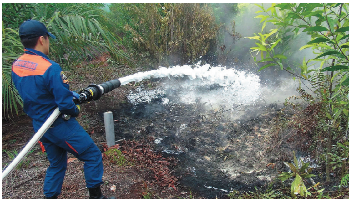
Pruebas sobre el terreno en incendios de turberas en Indonesia. Debido a su gran poder de ósmosis, la espuma puede apagar todas las brasas en la turba.
