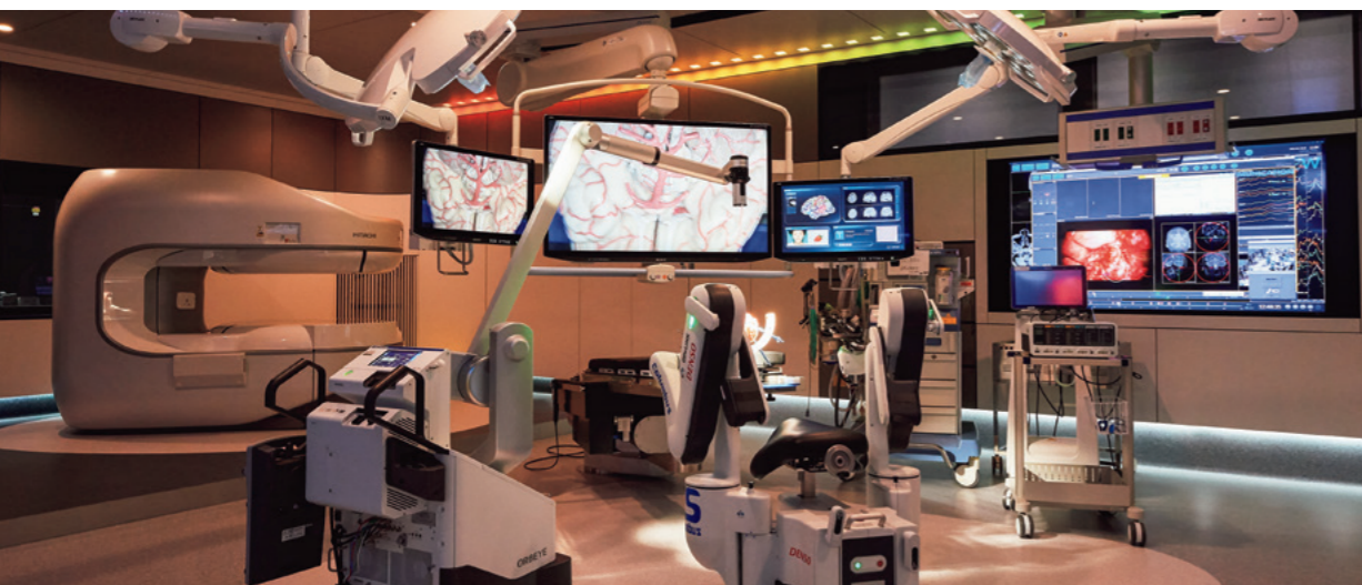
El interior de Hyper SCOT, en la Universidad Médica Femenina de Tokio, equipado con tecnología punta, incluidos una cama robot, un IRM abierto y una luz orgánica electroluminiscente. Más de veinte dispositivos médicos están conectados en red vía OPeLiNK, formando un espacio futurista que parece la cabina del piloto de un avión.
