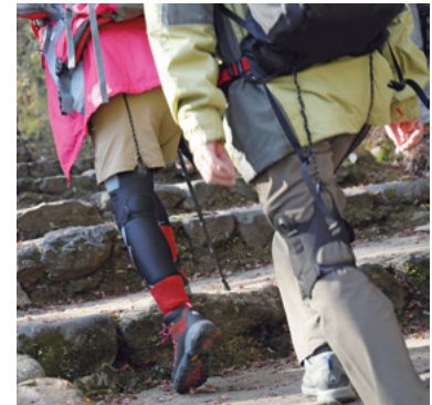
Participantes de un recorrido turístico usan el Himico, un exoesqueleto motorizado de apoyo para caminar.
