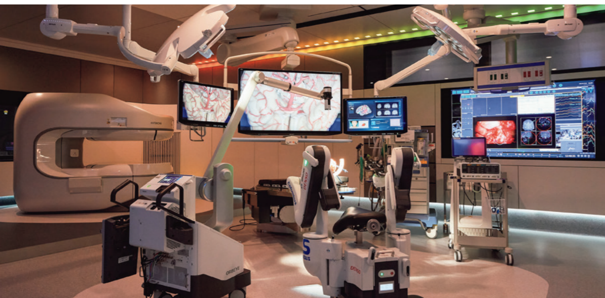
L'intérieur de l'Hyper SCOT à l'université médicale féminine de Tokyo, équipé avec des technologies de pointe, parmi lesquelles un lit robotisé, un scanner IRM à champ ouvert et un éclairage OLED. Plus de vingt appareils médicaux sont mis en réseau via OPeLiNK, s'agencant en un espace futuriste qui rappelle le cockpit d'un avion.
