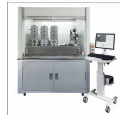
Regenova y una matriz de agujas kenzan real. Los esferoides de células se recogen y apilan uno a uno, lo que supondría una tarea realmente ardua para los seres humanos. En la actualidad, ya está disponible la tercera generación de Regenova, y se sigue investigando para lograr una producción de estructuras de mayor tamaño y unas operaciones cada vez más rápidas.
