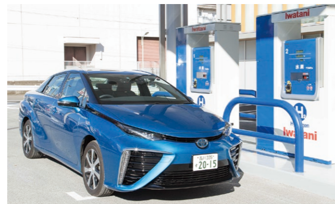
©Iwatani Corporation La Mirai, commercialisée en 2014 par Toyota Motor, est le premier véhicule mondial à pile à hydrogène produit en série.
