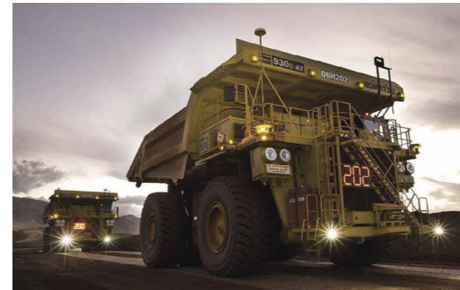
AHS est un système basé sur la technologie GPS, équipé d'un gyroscope pour détecter l'angle et la vitesse et d'un guidage laser pour contrôler à distance de gigantesques camions bennes sans opérateur. Il est utilisé dans la mine de cuivre de Chuquicamata au Chili, et la mine de fer de Yandicoogina en Australie.
