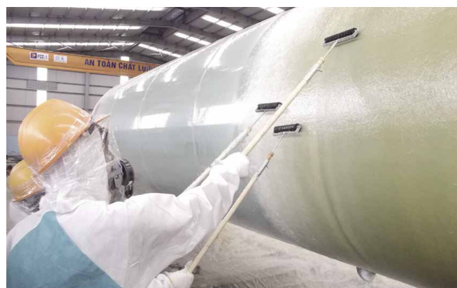
Sertissage manuel d'un réservoir avec du plastique renforcé de fibres, sous la supervision de Tamada Industries.
