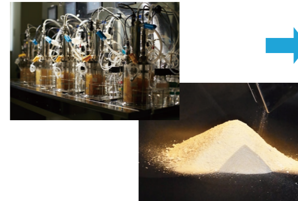
La fibroïne, protéine de la soie d'araignée, issue de la culture de micro-organismes, est pulvérisée.
