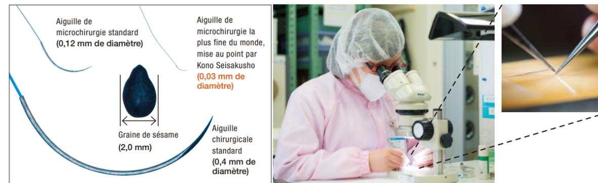
3. Une aiguille chirurgicale standard (en bas) et des aiguilles de microchirurgie fabriquées par Kono Seisakusho. La finesse des dernières est évidente. 4. Introduction d'un fil dans une aiguille de microchirurgie, à peine visible à l'œil nu, à l'aide d'un microscope et de pinces fines. Chez Kono Seisakusho, bien des opérations de précision telles que celle-ci sont confiées à des femmes.
