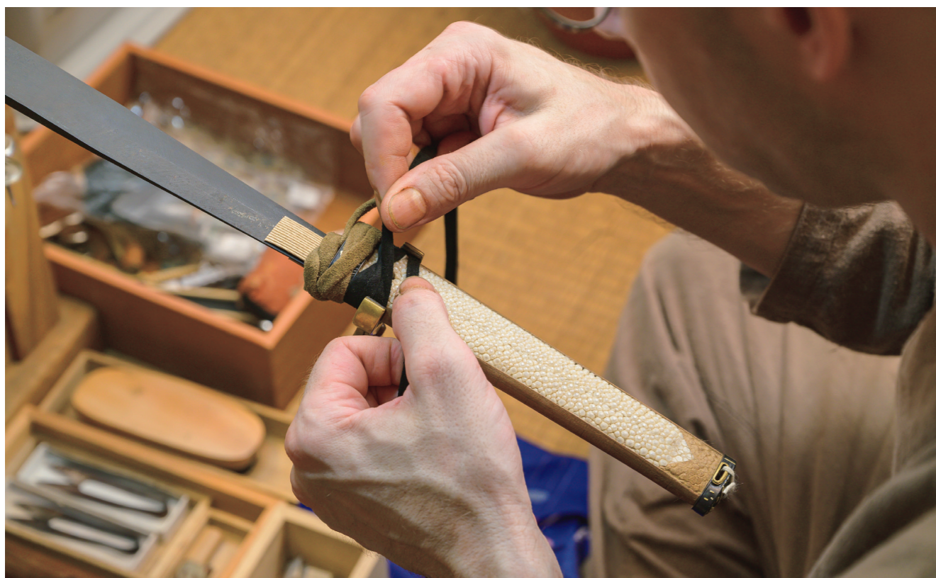
El proceso llamado tsukamaki (envoltura de la empuñadura) consiste en envolver un cordón de cuero alrededor de la empuñadura para reforzarla y proporcionar un mejor agarre. El tsukamaki en forma de diamante está hecho de una manera tan sólida que debe haber sido indestructible en el campo de batalla.
