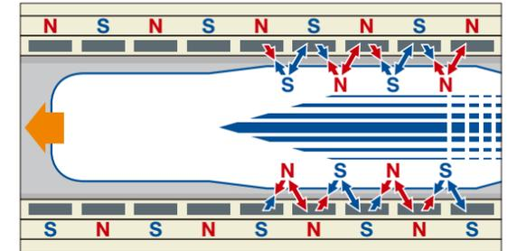
Le SCMaglev utilise de l'hélium liquide pour refroidir les bobines jusqu'à une température de moins 269 °C, ce qui les rend supraconductrices. Lorsqu'on fait passer du courant électrique à travers les bobines de propulsion disposées sur les rails de guidage, les forces de l'attraction magnétique générées entre elles et les aimants supraconducteurs placés sur le train propulsent celui-ci en avant. Au début, le train roule sur des pneus en caoutchouc, puis il commence à léviter à environ 160 km/h.
