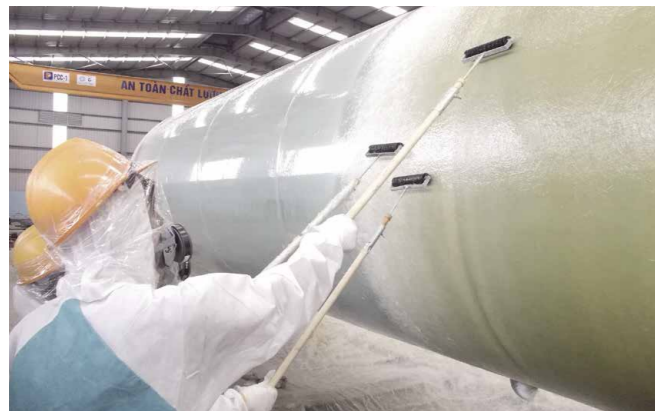
Bajo la supervisión de Tamada Industries, el PRF se aplica de forma manual en un tanque.
