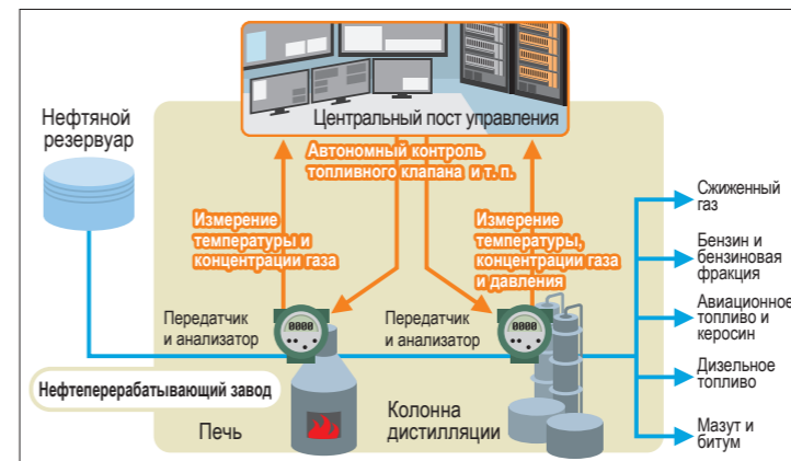
Основная продукция компании – системы управления производством для промышленных предприятий. Эти системы играют в производстве важную роль: собирая информацию с датчиков, анализаторов и других измерительных приборов, они отслеживают общее состояние производства, удерживая параметры работы производственного оборудования в оптимальных пределах.
