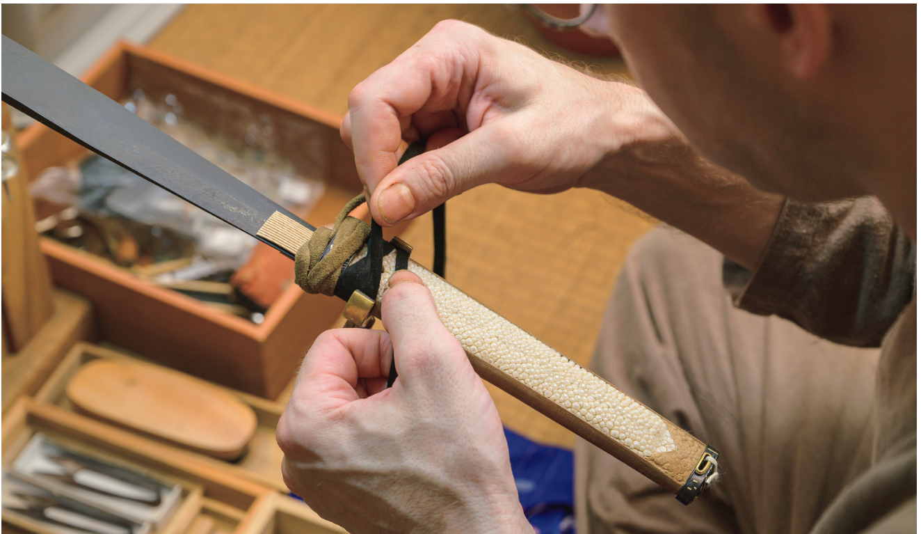
Le procédé appelé tsukamaki (tressage de la garde) consiste à enrouler des cordons de cuir autour de la garde du sabre afin de la renforcer et de permettre une meilleure prise. Le tressage du tsukamaki en diamant est si parfaitement serré qu'il ne fera jamais défaut à celui qui le possède sur le champ de bataille.
