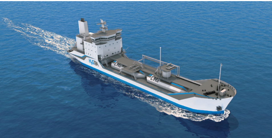
Infographie du premier transporteur d'hydrogène liquéfié au monde, qui sera utilisé pour le projet mené par l'HySTRA. À l'avenir, ces cargos eux-mêmes fonctionneront à l'hydrogène.
