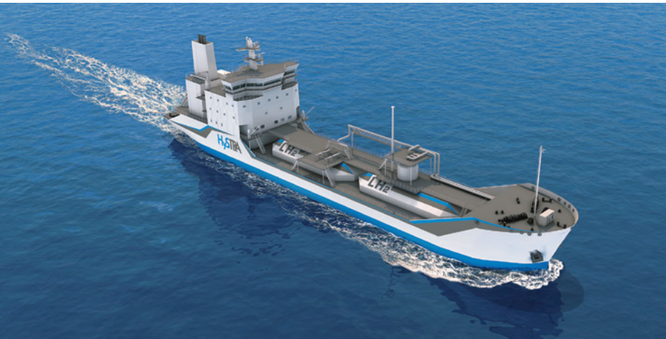
Gráfico computerizado del primer transporte de hidrógeno licuado del mundo que será usado por el proyecto liderado por HySTRA**. En el futuro también estos barcos que llevarán hidrógeno serán propulsados por ese mismo elemento.
