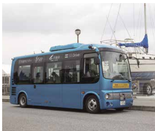
Le test SIP d'un système de conduite automatisée a été réalisé dans la ville de Ginowan, dans le département d'Okinawa. L'essai a utilisé le système satellitaire quasi-zénithal Michibiki et des cartes 3D de grande précision pour tester des bus sans chauffeurs. Les principaux objectifs de l'expérience étaient l'étalonnage et l'amélioration de la technologie des capteurs.
