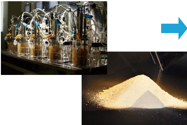
La fibroína, una proteína que se halla en la seda de araña, es producida por cultivos de microorganismos y reducida a polvo.
