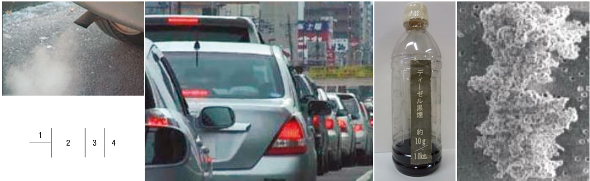
1 y 2. Cuando los vehículos diésel abundaban en las carreteras, los humos de escape provocaban un grave problema de contaminación en el aire tukiota. 3. Botella transparente con hollín. 4. Vista ampliada del hollín.
