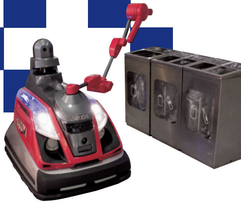
Cuatro robots de seguridad funcionan en el Aeropuerto Internacional de Narita. Los robots maniobran solos entre los usuarios del aeropuerto y se anuncian con la advertencia: "Patrulla".
