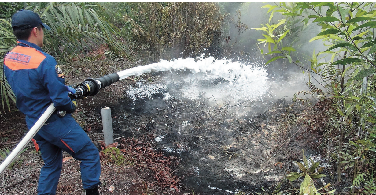
Pruebas sobre el terreno en incendios de turberas en Indonesia. Debido a su gran poder de ósmosis, la espuma puede apagar todas las brasas en la turba.
