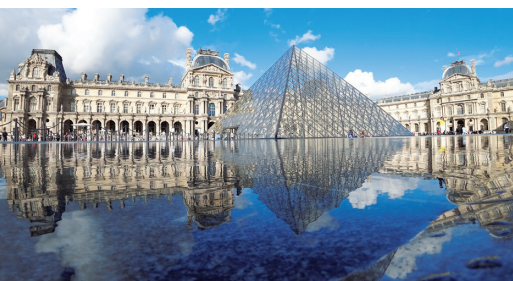
La fotocátalisis actúa con un efecto antiincrustante y antivaho simplemente por la irradiación de la luz. Ha sido usada en la pirámide de vidrio que cubre la entrada del Museo del Louvre. Al descomponer la suciedad, el vidrio mantiene su bella transparencia.
